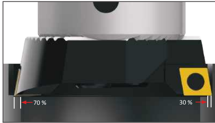
Materialabnahme von 7,00 mm - 10,00 mm im Durchmesser: Schruppen: 70 %, Schlichten: 30 %
