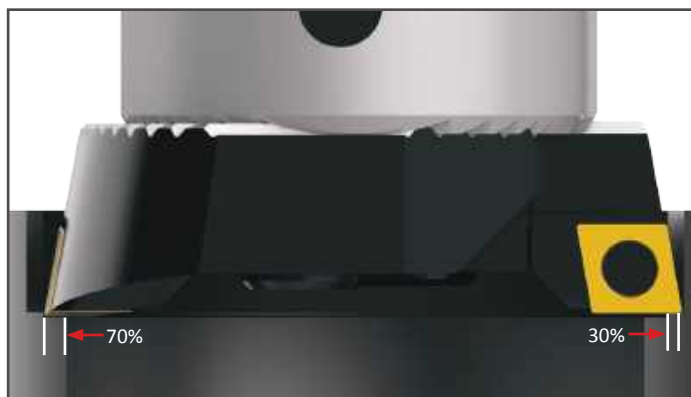
Eliminación de material hasta 0.276" - 0.394" (7.00 mm - 10.00 mm) de diámetro: 70% desbaste 30% acabado
