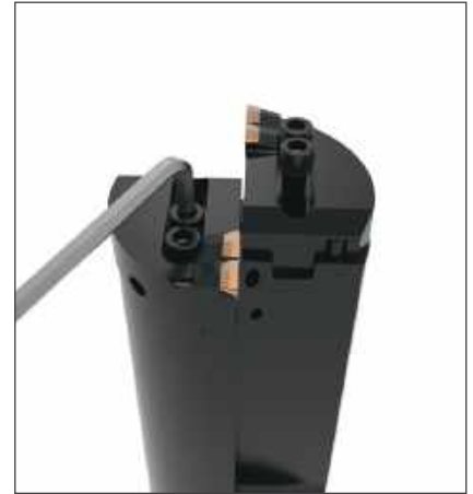
Stufe 3: Befestigungsschrauben am Plattenhalter mit 15-19 Nm anziehen.
