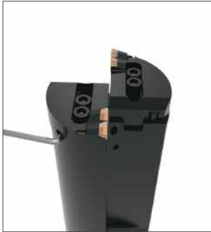
Stufe 2: Einen Plattenhalter mit Einstellschraube auf Bearbeitungsdurchmesser einstellen.
