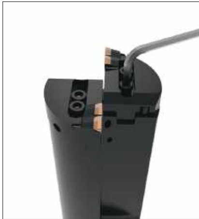
Stufe 5: Befestigungsschrauben am Plattenhalter mit 15-19 Nm anziehen.
