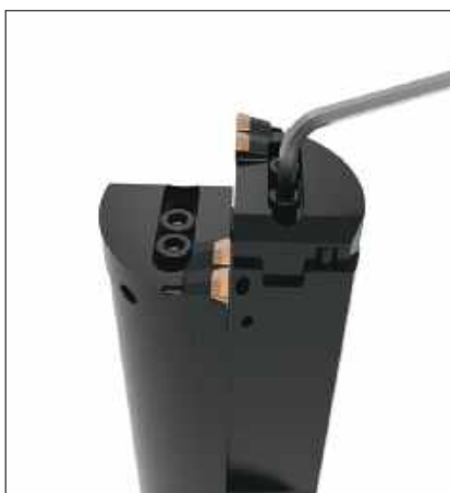
Étape 5: Serrez la vis de fixation à 15-19 Nm (11-14 ft-lbf).
