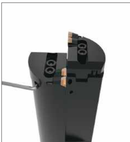
Étape 2: Fixez une cartouche au diamètre final requis en serrant la vis de réglage contre la goupille de maintien.
