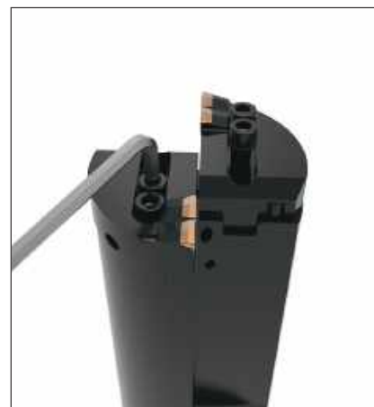
Étape 3: Serrez les vis de fixation sur la cartouche à 15-19 Nm (11-14 ft-lbf).
