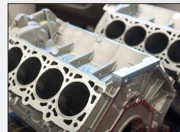
El cliente probó la **T-A Pro High Penetration Replaceable Insert Drill** utilizando el inserto de geometría "K" (hierro fundido) con recubrimiento TiAlN de múltiples capas de Allied que brinda mayor resistencia a la abrasión y mayor vida útil de la herramienta. La T-A Pro funcionó mejor de lo que el cliente esperaba.
